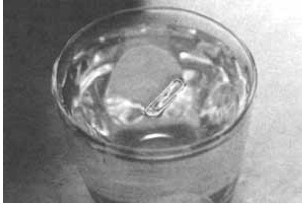
Figura 4. El clip puede flotar libremente en la superficie debido a la tensión superficial del líquido. En la antigüedad las brújulas se construían con una aguja imantada que flotaba sobre una palangana con agua, aprovechando este fenómeno.
