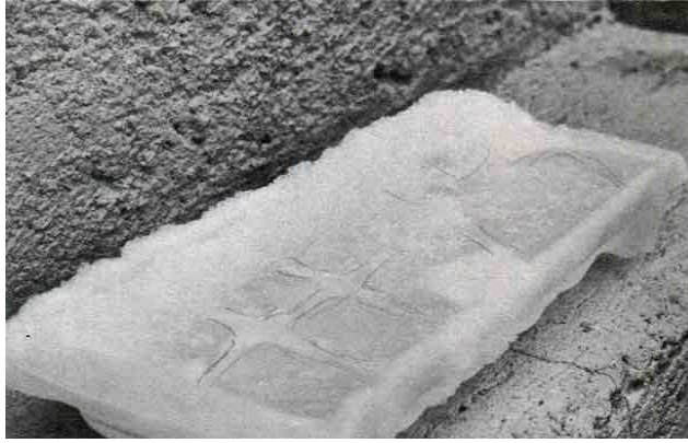
Figura 3. Cuando el agua líquida se solidifica aumenta su volumen debido a la manera como se conglomeran las moléculas. Esto se puede notar en una hielera.
